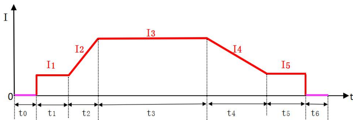
Obrázek 7-5 Průběh proudu DC TIG
